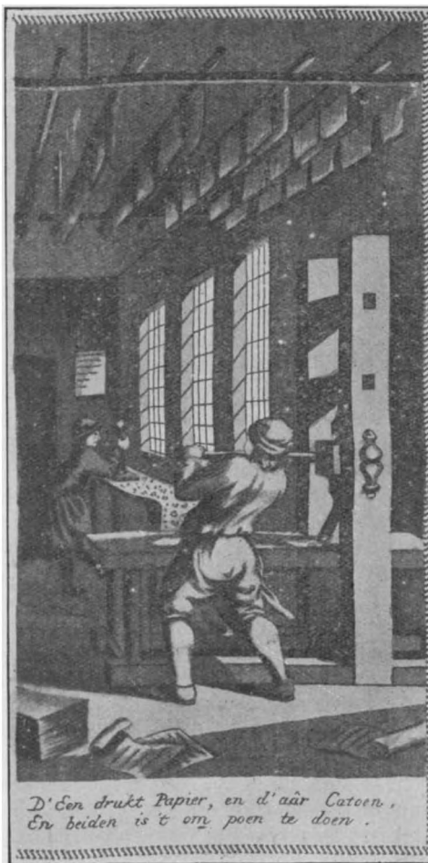
Katoendrukkerij: op den voorgrond een drukpers waarop sitspapier wordt gedrukt, terwijl op den achtergrond katoen met de hand van patronen wordt voorzien.
